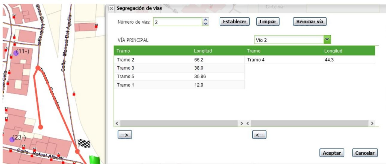
Ilustración 38: Ejemplo de segregación de una vía en dos vías resultantes
